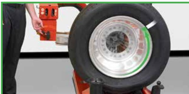
Durch eine an den Hochpunkt des Reifens und den Tiefpunkt der Felge angepasste Montage rollt das Rad so ruhig wie möglich.
