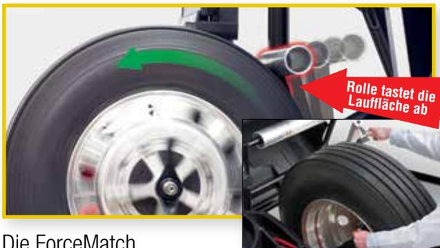
Die ForceMatch HD-Auswuchtmaschine misst schnell den Höhenschlag (Exzentrizität) einer Reifen- und Radbaugruppe.
