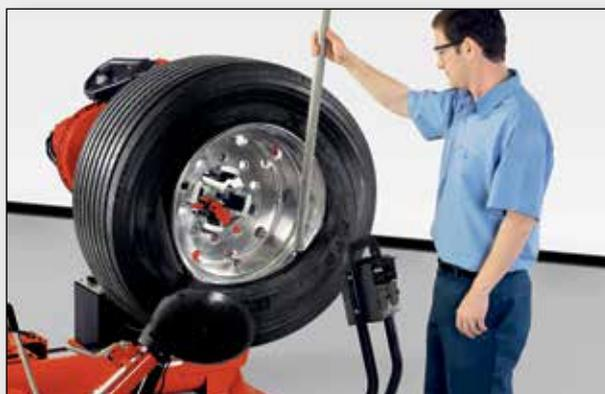
Das Standard-Hakenwerkzeug wird für die Montage und Demontage von Schlauch- und Super-Einzelreifen oder schwierigen Radbaugruppen verwendet.
