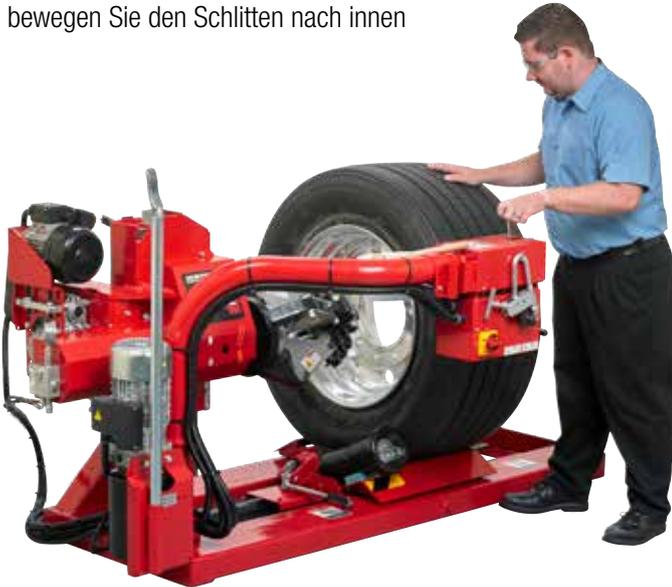
Einfache Montage mit optionalem Special Hebel abgebildet
