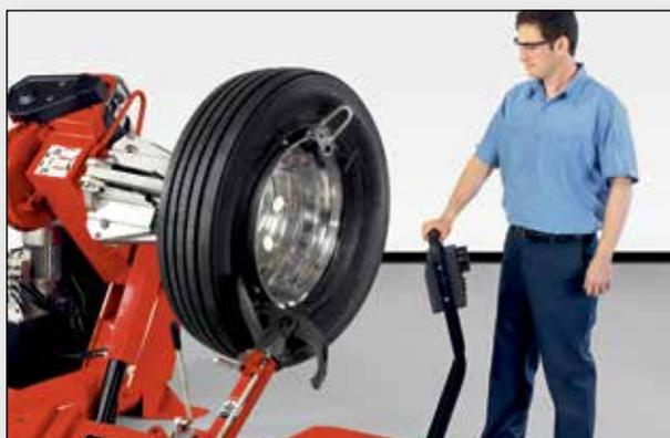
Die Radzange positionieren und den ersten Wulst auf die Felge rollen. Die Zange neu positionieren und den zweiten Wulst aufrollen.
