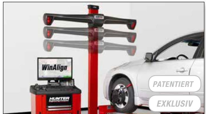
Standard Säule mit manuell betätigtem Kameralift. Erlaubt Vermessungen der untersten bis obersten Stellung der Hebebühne.
